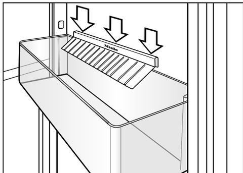
Plastični nastavci držača za boce zadiru u površinu za boce te prilikom otvaranja i zatvaranja vrata uređaja, na taj način bocama pružaju bolju stabilnost.
